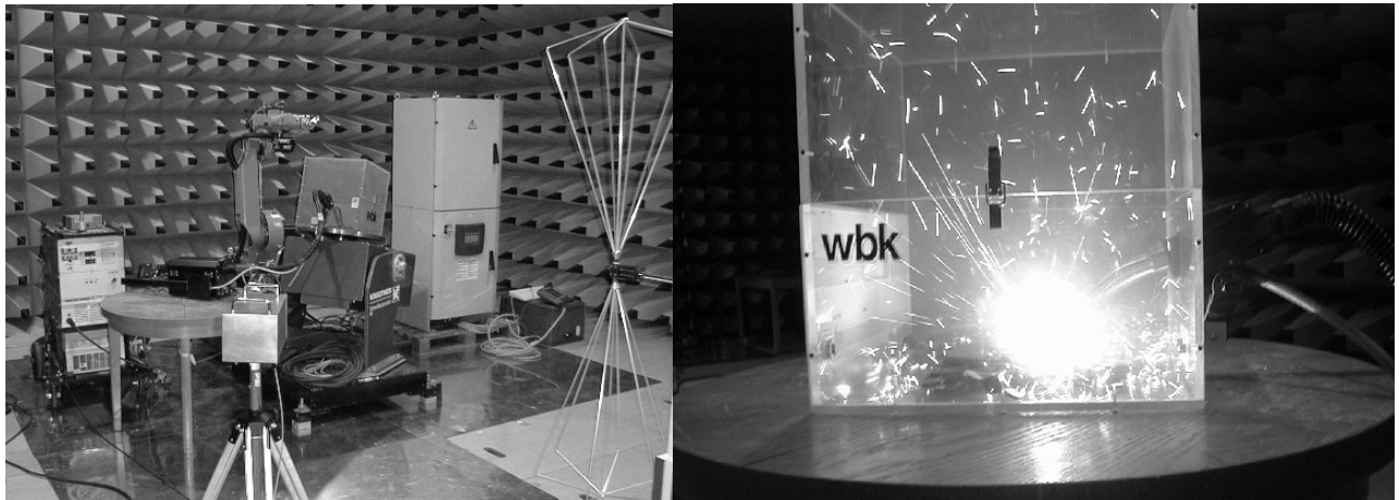
Abb. 2.1 Anlagenaufbau in der Absorberhalle und abgeschirmter Lichtbogen
